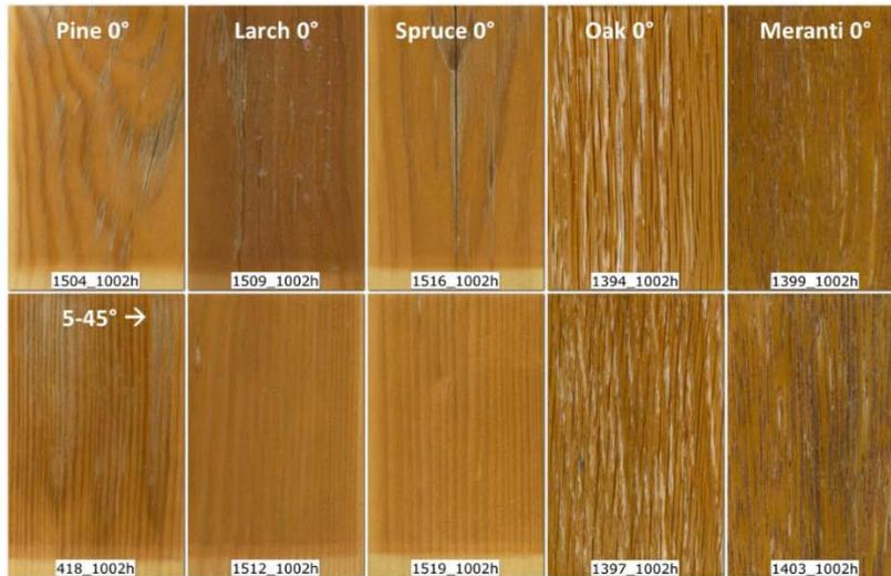
Abbildung 8: Einfluss der Holzart und Jahrringlage (0° und 5°-45°) auf die Dauerhaftigkeit einer Beschichtung (Bilder: HFA)
